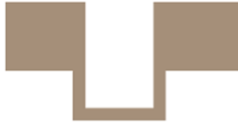
شکل ۱۳-۴: مقطع مدل شالوده در حالتی که شالوده‌ها اختلاف تراز داشته باشند
