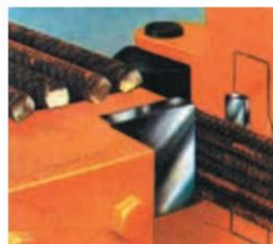
شکل ۵۷-۲- برش چند میلگرد آجدار به وسیله تیغه ماشین برقی برش میلگرد
