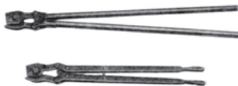
شکل ۵۳-۲- قیچی های دستی ساده برای برش میل گرد فولادی
