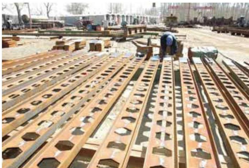
شکل ۴-۷- پر کردن حفره ها توسط ورق تقویت کننده
