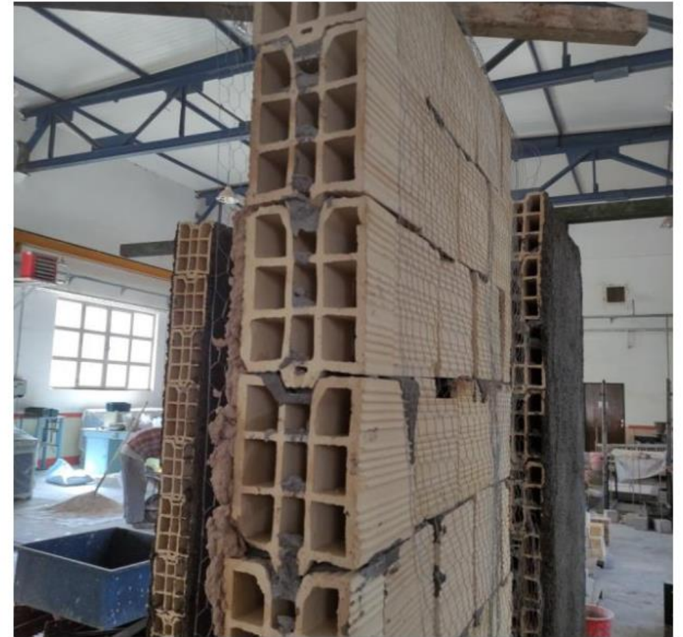
شکل ۷-۱۱: نحوه مسلح سازی دیوار با توری مرغی گالوانیزه
