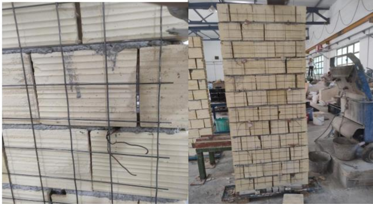
شکل ۲-۱۰: نحوه مسلح سازی دیوار با شبکه فولادی
