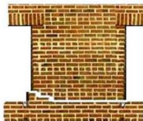
الف) مود شکست بر اثر لغزش درز ملات
