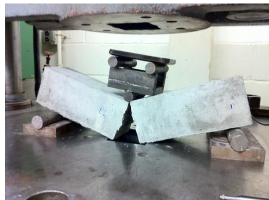
شکست تیر بتنی تحت خمش
