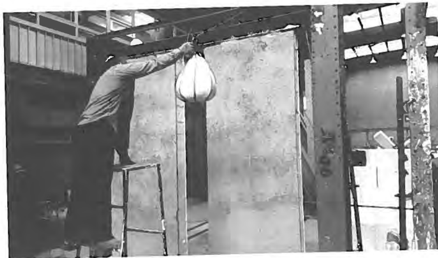
شکل (۵-۱) آزمایش ضربه جسم نرم سنگین
