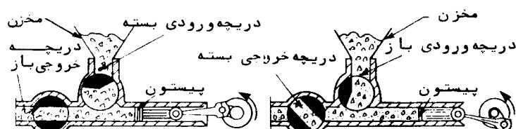
شکل ۴۵. پمپ پیستونی (تلہمای)
