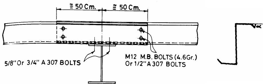
شکل ۸-۷ نمونه ای از اتصال لایپها برای انتقال لنگر خمشی [۳]
