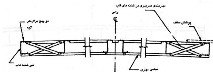
شکل ۸-۸-ب مهاربندی لایه‌ها به وسیله نبیشی و اتصال به کمک پیچ خودکار [۱۷]
