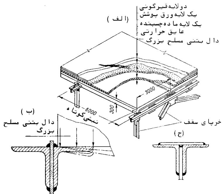
شکل ۷-۷ سقف‌سازی با عایق حرارتی بدون لایه [۲]
