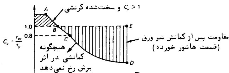
شکل ۱۳-۳ ظرفیت برشی ورق جان با توجه به مقاومت پس از کمانش آن
