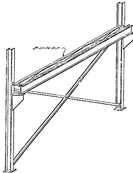
شکل ۱۳-۹ مهاربندی ریل‌های جرثقیل [۲]
