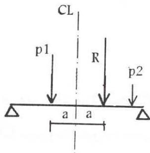
تیرهای باربر نباید مانع برای حرکت جرثقیل در طول تیر ایجاد کنند. حداقل خیز مجاز برای تیرهای باربر جهت جلوگیری از مشکلات حرکتی (ناشی از خیز زیاد) و در نظر گرفتن آثار دینامیکی بار (به علت ارتعاش ایجاد شده در جرثقیل) به  $\frac{1}{1000}$  طول دهانه محدود شده است.
