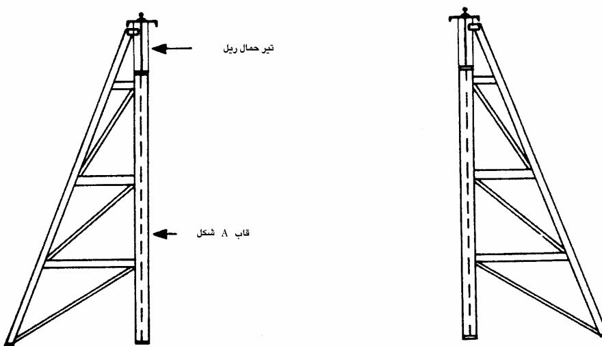
شکل ۴-۹-الف تکیه‌گاه‌های ریل داخل ساختمان برای جرثقیل‌های بالاتشین [۱۶]
