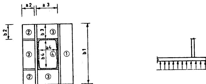
شکل ۱۲-۲۳- تقسیم محل اتکا به ۴ منطقه متفاوت [۱۴]
