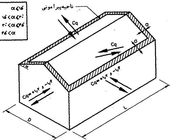
شکل ۱۴-۸ ضریب شکل  $C_q$  برای دیوارها، پوشش بام‌ها و عناصر سازه‌ای نگهدارنده آنها [۱۲]
