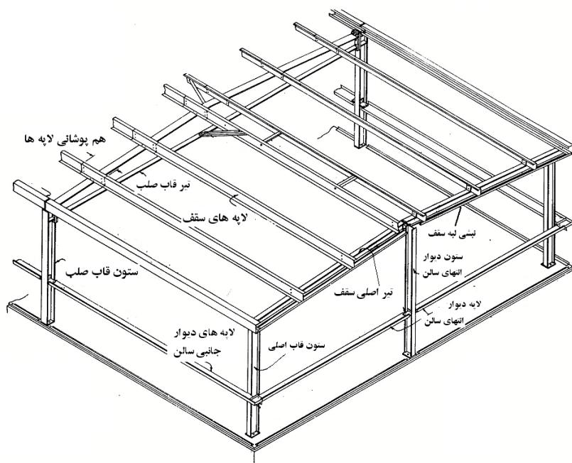
شکل ۱-۸ نمای کلی لایه‌های سقف و دیوار [۱۷]
