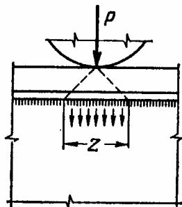
شکل ۶-۵ توزیع بار مرکز چرخ جرثقیل در ناحیه اتصال جان و بال تیر [۳۵]
