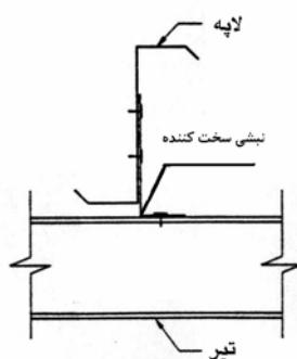
شکل ۳-۸ استفاده از نبشی سخت‌کننده جهت کنترل لهیدگی جان [۱۷]
