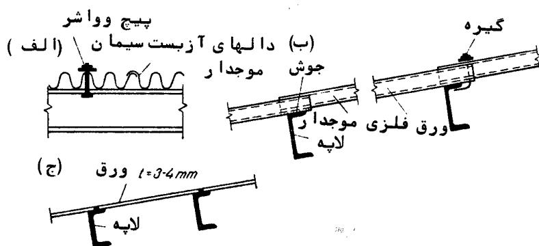
شکل ۳-۷ انواع پوشش سقف بدون عایق حرارتی [۲]
