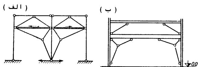
شکل ۱۱-۹ مهارهای قائم قابی الف- فاصله ۶ متری ستونها، ب- فاصله ۱۲ متر یا بیشتر ستونها [۲]
