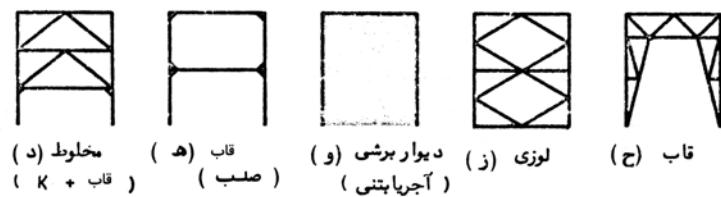
شکل ۹-۷ انواع سیستم‌های مهاربند جانبی [۲]
