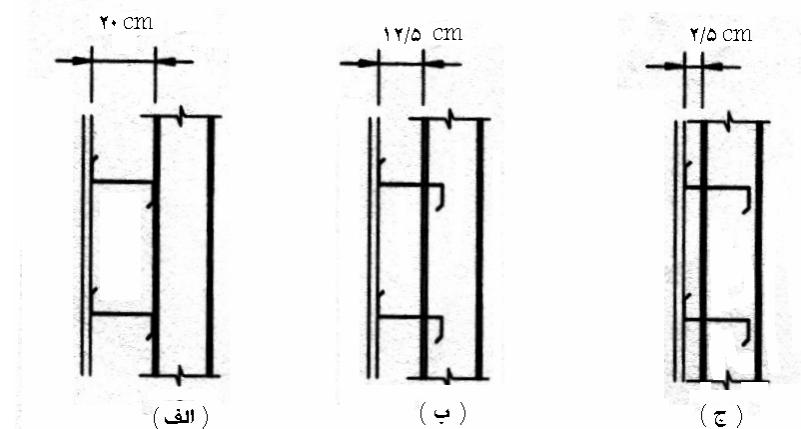
شکل ۱۵-۸ نصب لape‌های دیوار (الف) روکار (ب) نیمه روکار (ج) توکار [۱۷]
