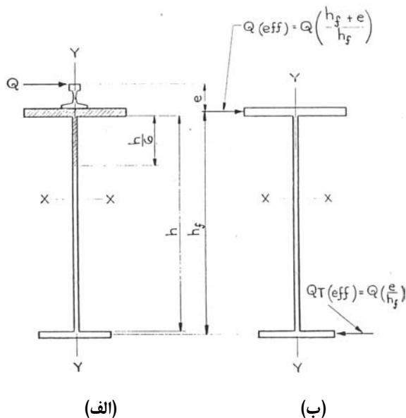
شکل ۶-۱ سطح مقطع موثر در محاسبه تنفس ناشی از بار جانبی و بار جانبی اصلاح شده [۱۵]
