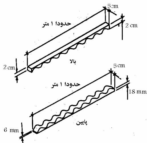
شکل ۴-۷-د نوارهای درزگیر مطابق موج ورق سقف
