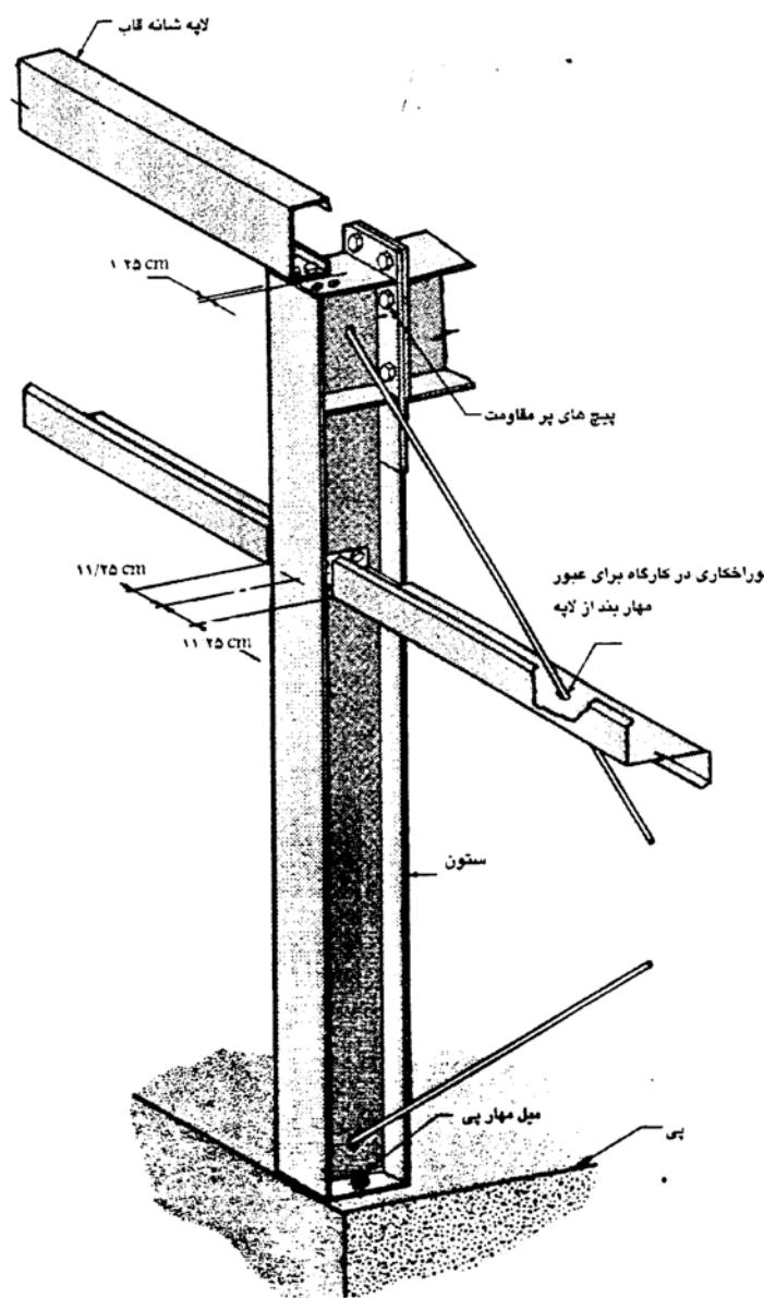
[۱۷] شکل ۸-۱۷ نحوه نصب تو کار برای لape های دیوار
