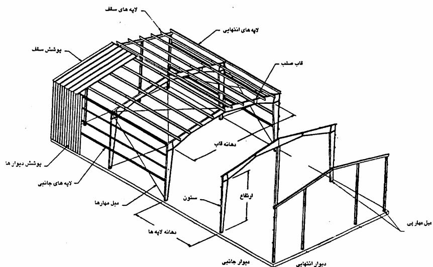
شکل ۱-۲-۱-ب قطعات اصلی ساختمان صنعتی با قابهای مسطح عرضی [۱۷]
