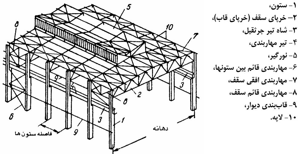
شکل ۱-۲-۱-الف قطعات اصلی قاب‌بندی ساختمان صنعتی دارای خرپای سقف [۲]
