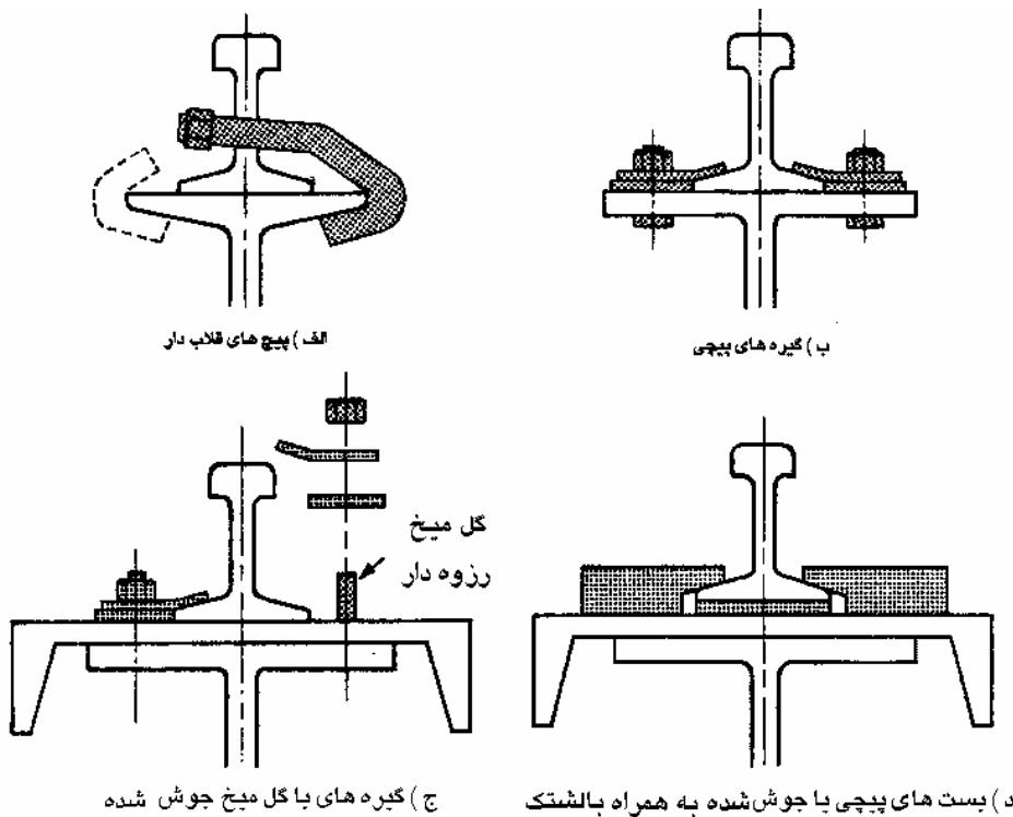
شکل ۷-۴ روش‌های متدائل محکم کردن ریل به تیر باربر [۱۶]
