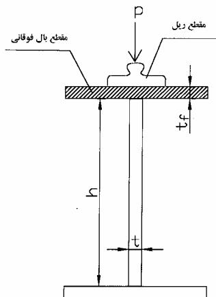
رابطه فوق بر تئوری تیر بر بستر الاستیک با فرض تماس فولاد با فولاد استوار است. فرض شده است که ممان اینرسی مجموعه ریل و بال تیر برابر مجموع ممان اینرسی هر یک از آنهاست. از آثار اصطکاک، گسترش بار چرخ و سهم جان تیر در افزایش سختی خمشی بال فوکانی تیر صرف نظر شده است.
