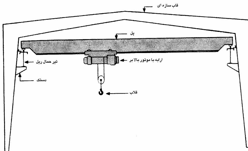
شکل ۴-۱-۱-۴-الف جرثقیل پل دار بالانشین با ارابه آویخته [۱۶]
