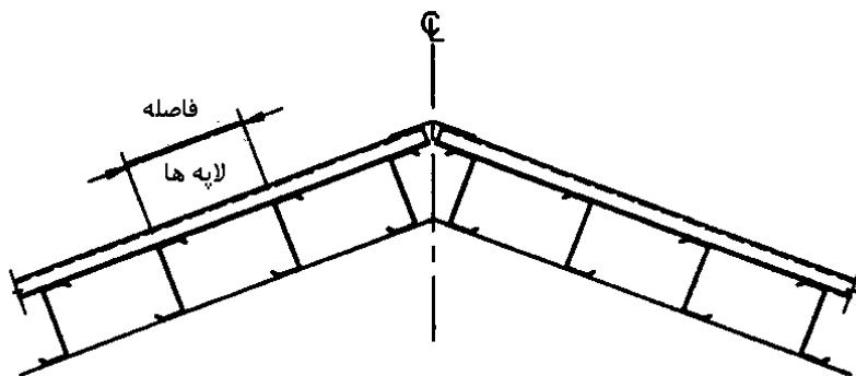
شکل ۸-۶ جهت‌گیری مناسب لپه‌ها در سقف‌های شیبدار با شیب بیش از ۱:۲۴ [۱۷]
