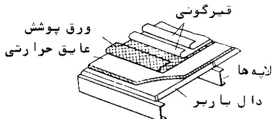
شکل ۱-۷ سقف‌سازی با عایق حرارتی با لایه [۲]
