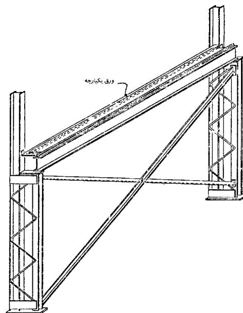
شکل ۱۲-۹ مهاربندی ریل‌های جرثقیل [۲]
