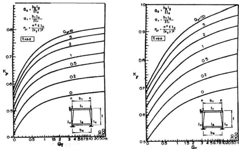
شکل ۱-D1-۳ ضریب طول مؤثر برای ستون‌های با مقطع متغیر حرکت جانبی آزاد  $\gamma = 0.5$  [۷]شکل ۱-D1-۴ ضریب طول مؤثر برای ستون‌های با مقطع متغیر حرکت جانبی محدود  $\gamma = 0$  [۷]
