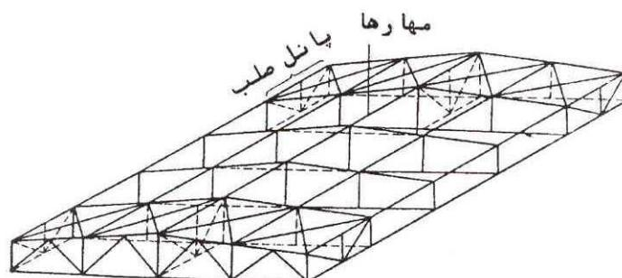
شکل ۷-۷ مهارهای بین خرپاهای سقف [۲]
