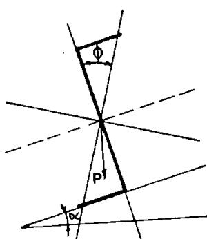
شکل ۱۱-۸ محورهای پروفیل  $Z$  در روی سطح شیبدار
