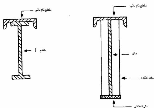
شکل ۸-۴ مقاطع متداول تیر باربر ریل برای جرثقیل‌های بالانشین [۱۶]
