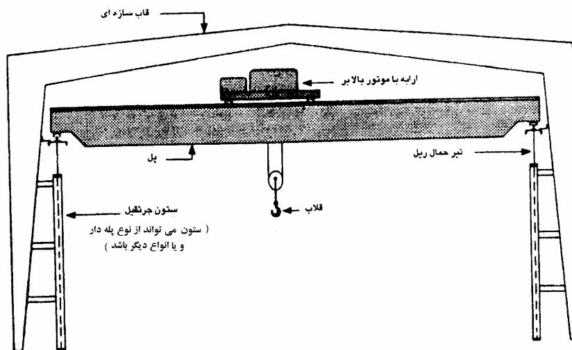
شکل ۴-۱-۶-ب جرثقیل پل دار بالاتشین با ارابه بالاتشین [۱۶]
