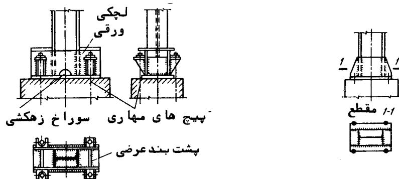
شکل ۸-۱۴ استفاده از قطعات ورق و یا لچکی [۱۴]
