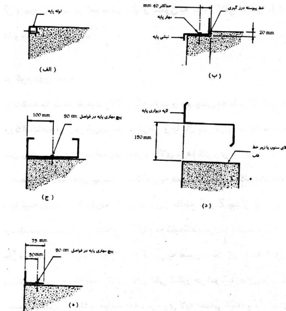
شکل ۱۹-۸ جزئیات انواع مختلف تکیه گاه پانل ها [۱۷]
