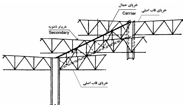
شکل ۳-۱ اتكای خرپاهای سقف بر روی خرپاهای ثانویه [۲]
