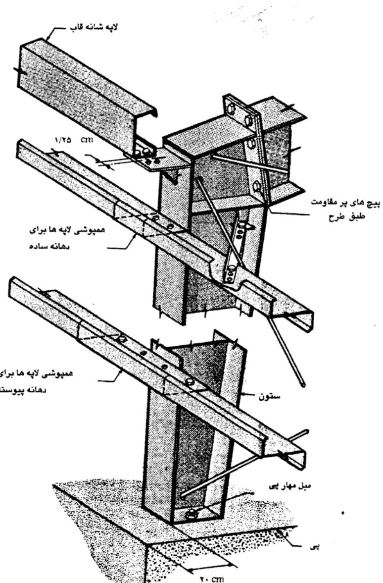
شکل ۸-۱۶ نحوه نصب روکار برای لپه‌های دیوار [۱۷]
