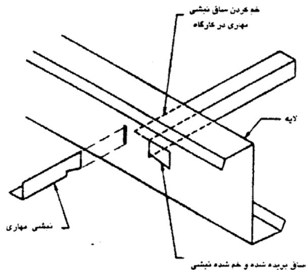
شکل ۸-۸-الف مهاربندی لایه‌ها با استفاده از نبیشی [۱۷]
