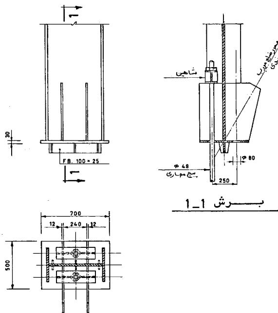
شکل ۱۶-۱۲ انتقال برش به شالوده با استفاده از زبانه [۱۴]
