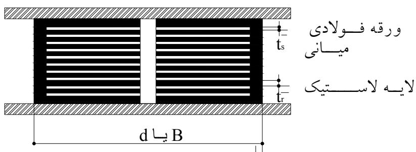
شکل ۲-۳- مقطع جداساز لاستیکی با ورقه‌های فولادی
