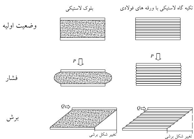
شکل ۳-۲- تاثیر ورقه‌های فولاد بر روی سختی قائم جداساز لاستیکی
