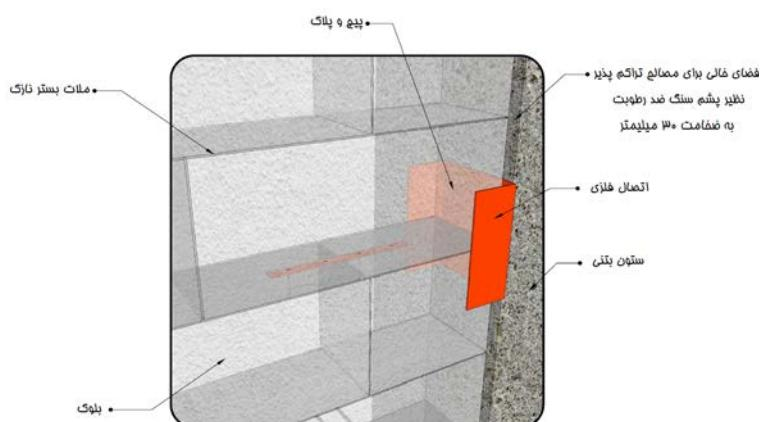
شکل ۱۳-۱۲- مهار دیوار خارجی ساخته شده از بلوک به ستون با استفاده از نبشی یا ناودانی
