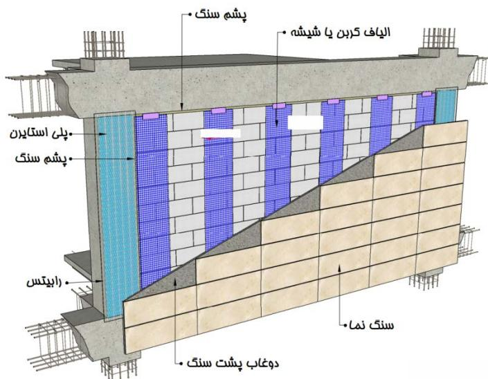
شکل ۴-۲۰-۴- نحوه اجرای نمای چسبانده شده در دیوارهای جداسازی شده مسلح شده با شبکه الیاف
