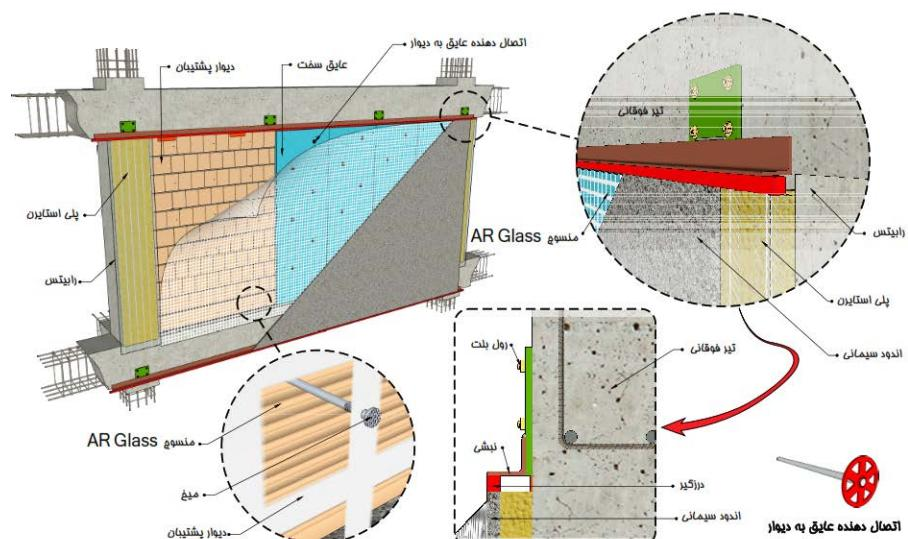
شکل ۱۱-۲۱- جزئیات نمای بتن مسلح در دیوارهای نیازمند به عایق حرارتی مانند سفال
