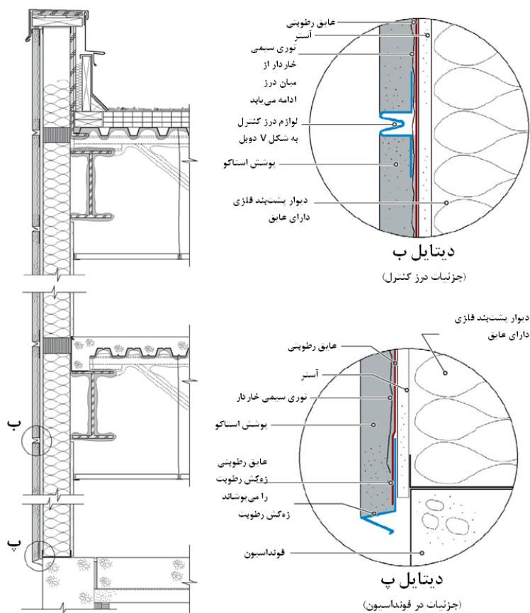
شکل ۶-۰۶ - یک نمونه مقطع دیوار و جزئیات متناظر از یک ساختمان قاب فلزی پوشانده شده با نمای سیمانی
