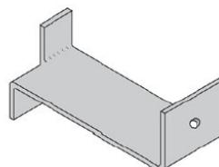
شکل ۷-۴-نمونه‌ای از مهارهای دم دو تکه
