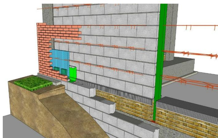
شکل ۱-۵- اجرای نمای آجری بر روی دیوار مسلح شده براساس ضوابط فصل دوازدهم
