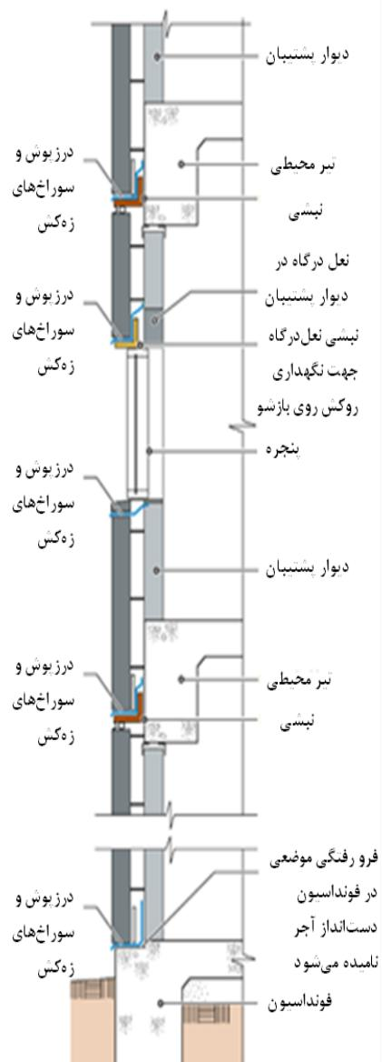
شکل ۵-۵- نمای شماتیک از قرارگیری نبشی‌های تکیه‌گاهی و نعل درگاهی و درزگیرها
