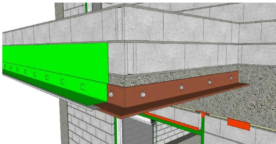
شکل ۵-۲۲-۵- استفاده از ماده مخصوص جلوگیری از نفوذ آب و هوا قبل از اجرای نمای آجری
