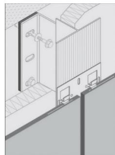
الف- نمونه اجرای اتصال لوپیایی به تیر در اجرای خشک نمای سرامیکی
