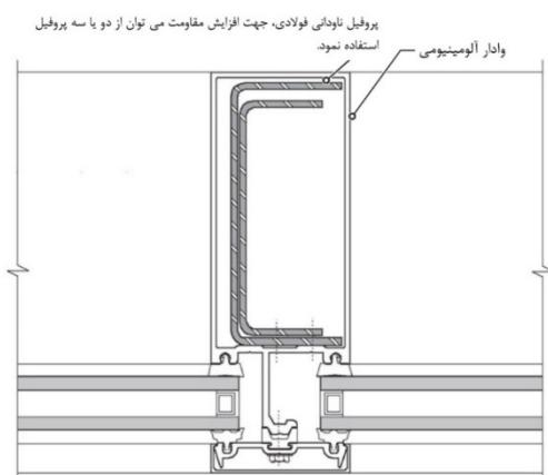
شکل ۲۰-۹- افزایش مقاومت وادارها بوسیله مقاطع فولادی
