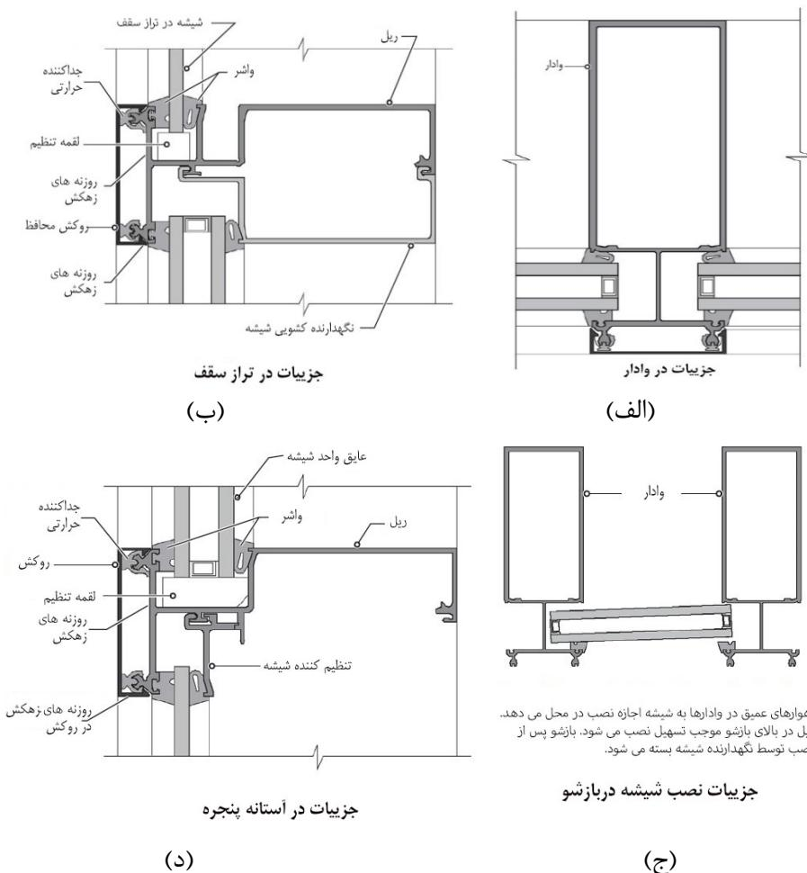
شکل ۹-۱۷-۹- جزییات دیوار پرده‌ای شیشه‌ای با شیشه نصب شده از داخل
