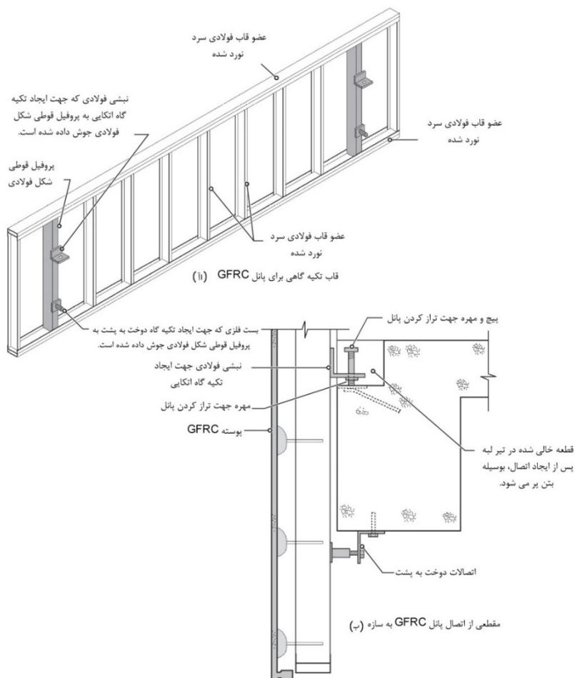
شکل ۱۶-۱۱- تصویری شماتیک از جزئیات اتصالات اتکایی و دوخت به پشت در پانل‌های پیرامونی GFRC
