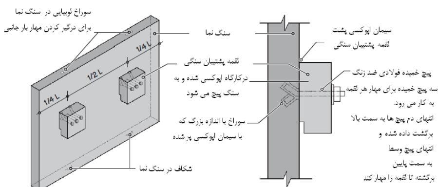
شکل ۴-۵-۴-۵- مهار سنگ نما به کمک لقمه پشتیبان، قطعه سنگ نما همراه با قطعات لقمه سنگی نصب شده در فاصله ۲۵٪ طول قطعه
