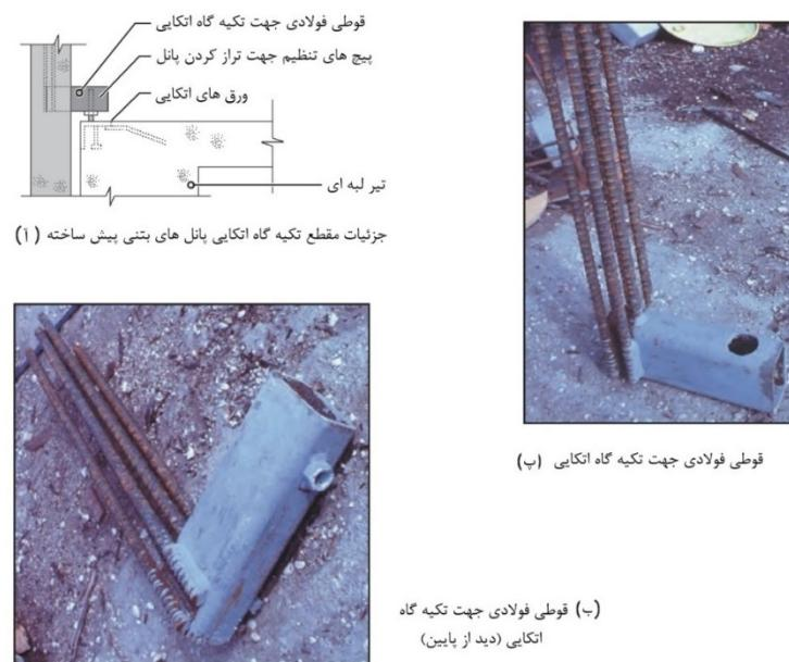
شکل ۱۰-۵- پروفیل قوطی شکل به عنوان تکیه گاه انتکابی و پیچ تنظیم ارتفاع
