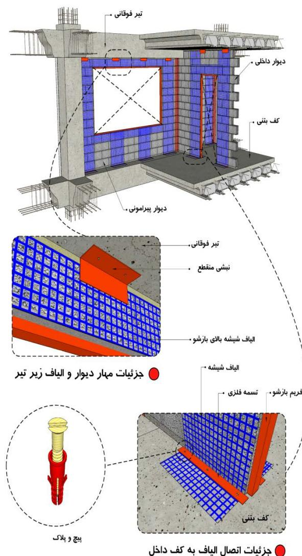
شکل ۱۲-۲۷-۲۸-۱۲- تسليح دیوار در مجاورت بازشو با استفاده مش الیاف - وجه داخلی دیوار
