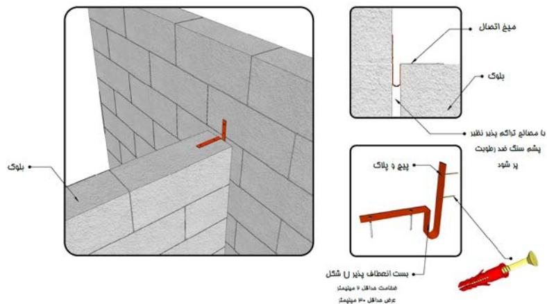
شکل ۱۲-۲۲- اجرای دیوار متقطع با استفاده از بست انتطاف پذیر
