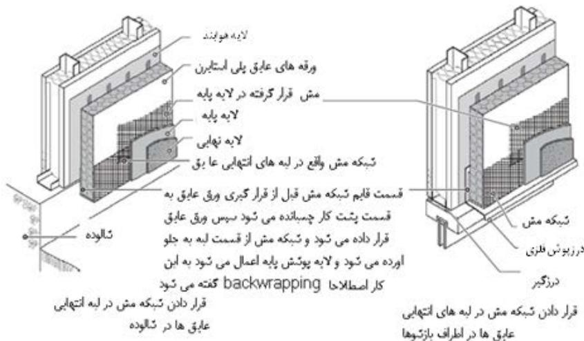
شکل ۱۱-۶- قرار دادن شبکه الیاف در اطراف بازشوها
