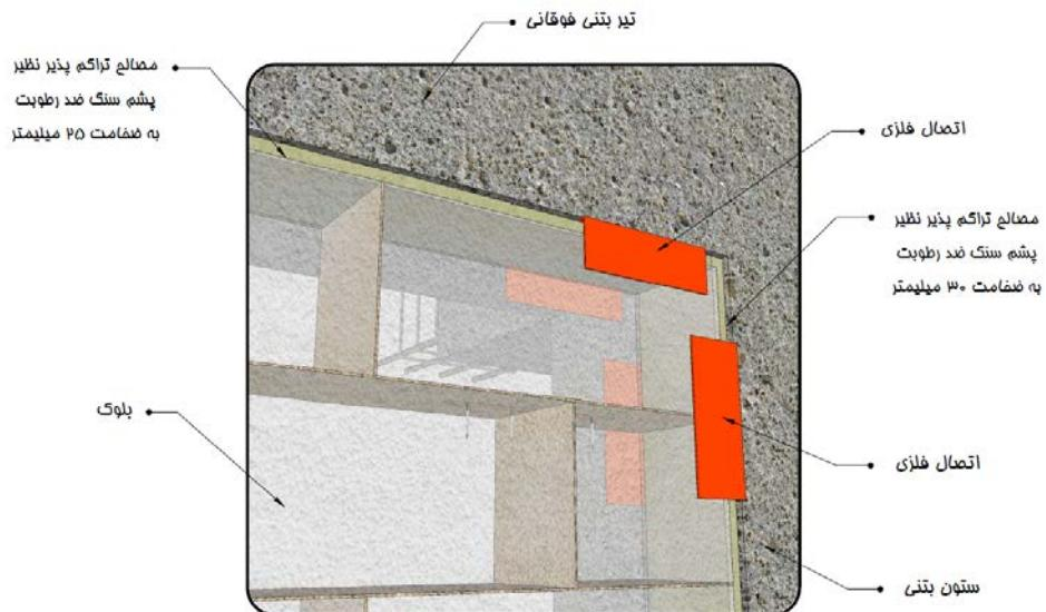
شکل ۱۵-۱۲- جزییات اجرایی در محل تلاقی دیوار با سقف - اتصال دیوار به سقف با استفاده از نبشی
