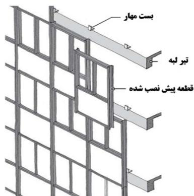
شکل ۲-۹- سیستم نمای پرده‌ای یک پارچه
