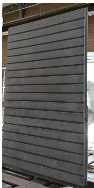
شکل ۱۵-۱۱- نمونه‌ای از نمای نازک بتنی با مواد پلیمری در پانل GFRC
