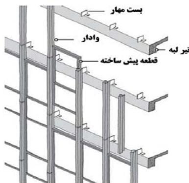
شکل ۳-۹- سیستم نمای پرده‌ای شامل قطعه-وادار
