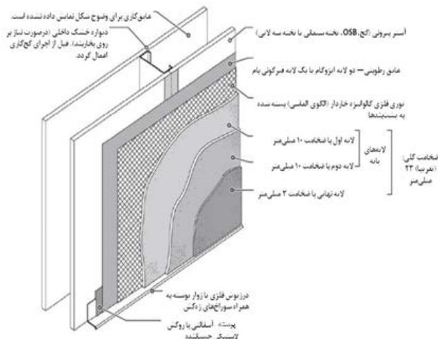
شکل ۱-۶ ساختار اجرای نمای سیمانی روی دیوار خشک
