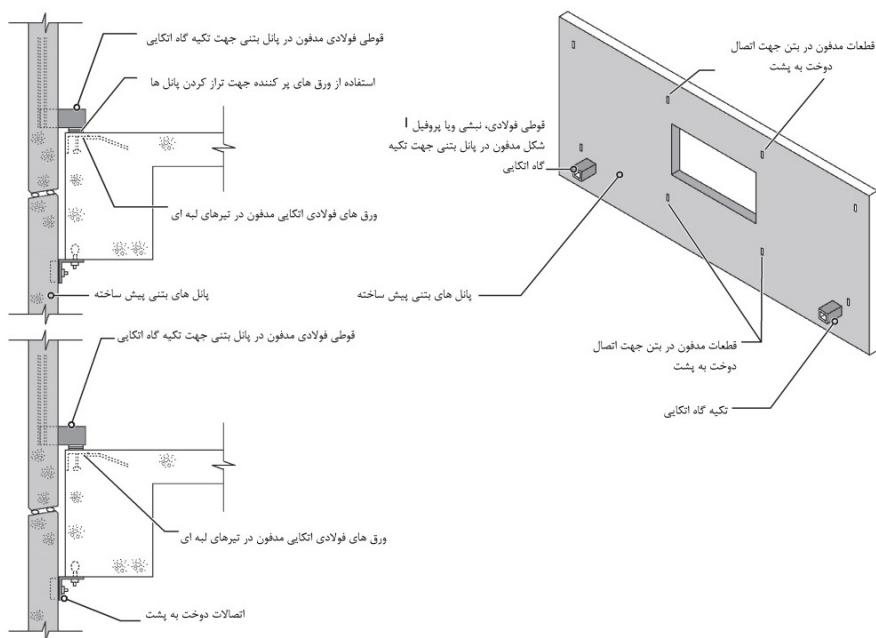
شکل ۴-۱۵- تیپ اتصالات تکیه‌گاهی یک پانل بتُنی پیش‌ساخته
