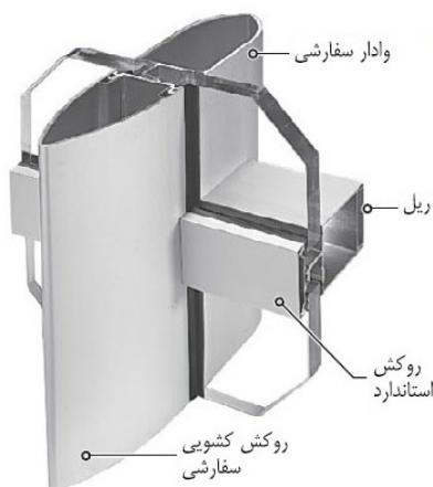
شکل ۹-۱۴- روکش و وادر سفارشی برای نمای پرده‌ای شیشه‌ای با شیشه نصب شده از خارج
