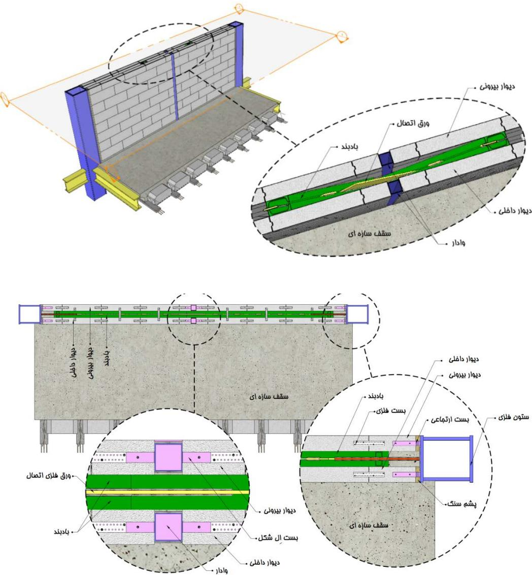
شکل ۱۲-۱۶- نمونه ای از اجرای دیوار با ملات بستر نازک در دهانه مهاربند
