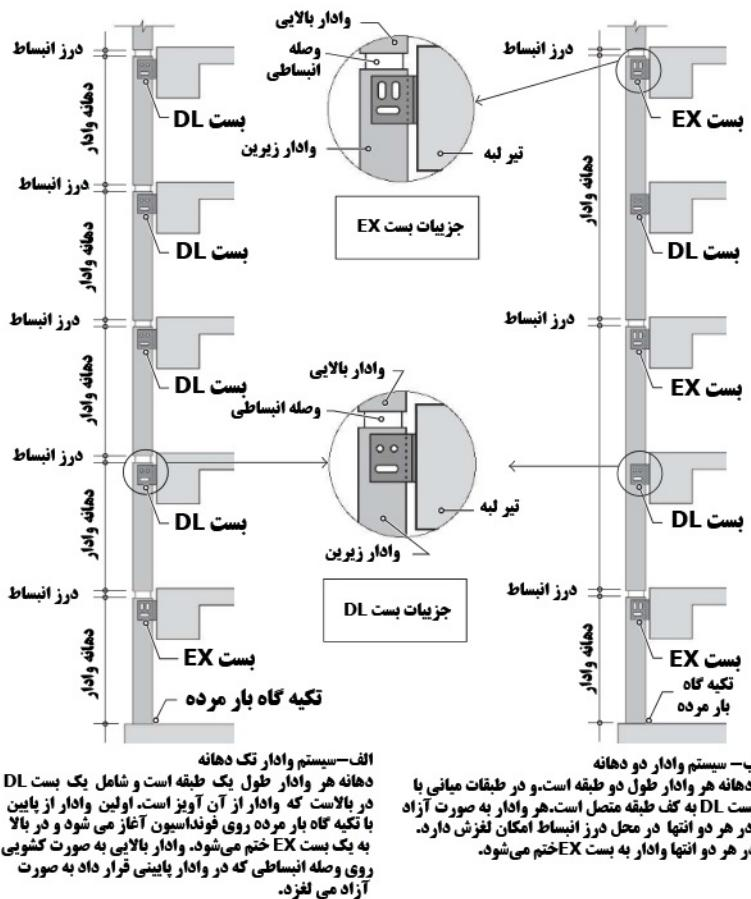
شکل ۸-۹- سیستم‌های تکیه‌گاهی برای دیوارهای پرده‌ای شیشه با وادر تک و دو دهانه
