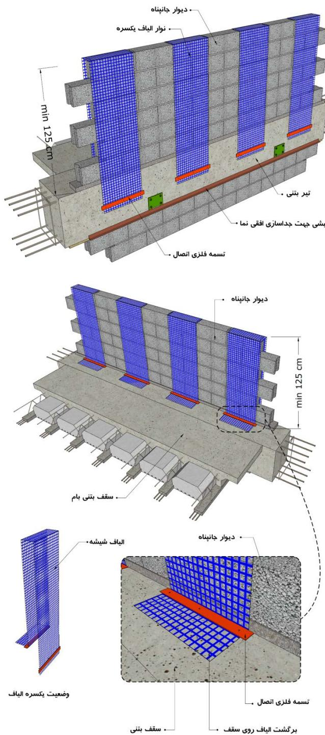
شکل ۱۲-۳۵- نمونه‌ای از تسلیح دیوار جان پناه با استفاده ملات مسلح شده با مشن الیاف و جزییات اجرای آن
