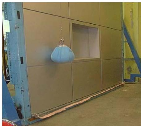
شکل ۳-۵-آزمایش ضربه جسم نرم سنگین روی نما
