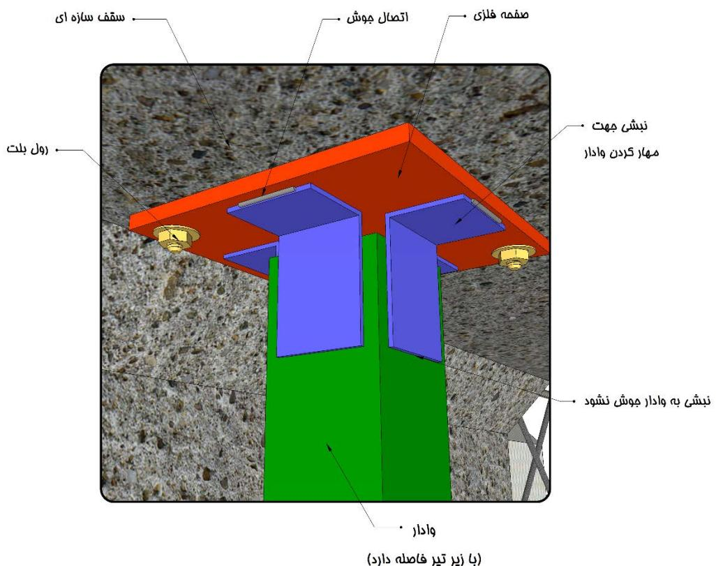
ب- اتصال وادر انتهایی در دیوارهای خارج از قاب به صورت تلسکوپی
