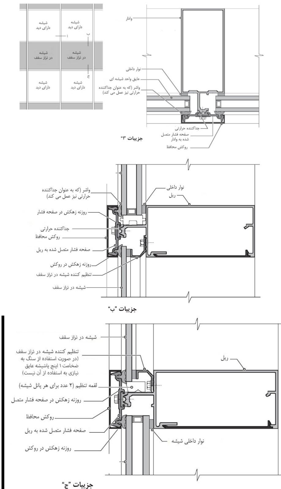
شکل ۱۵-۹- انواع جزئیات نمای پرده‌ای شیشه‌ای با شیشه نصب شده از خارج (صفحه فشار نگدارنده شیشه)
