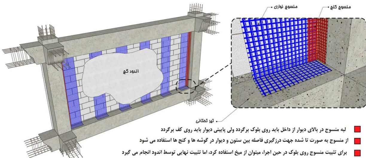
شکل ۲۰-۱۲- مسلح کردن دیوارها با استفاده از نوارهای شبکه‌ای الیاف شیشه (سطح داخلی دیوار)
