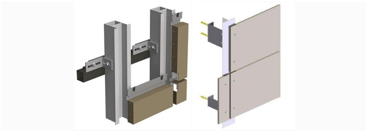
شکل ۲-۸- نمونه‌ای از اجرای ثابت
