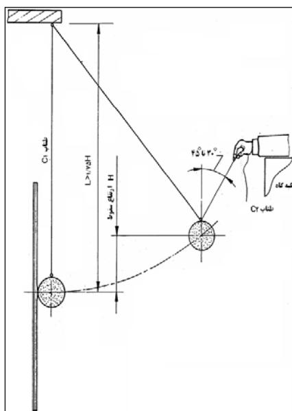
شکل ۳-۱-۳- انجام آزمایش ضربه جسم سخت
