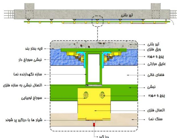
شکل ۱۴-۴- جزییات اتصال مهار سنگ به سازه نگهدارنده نما و تیر بتونی
