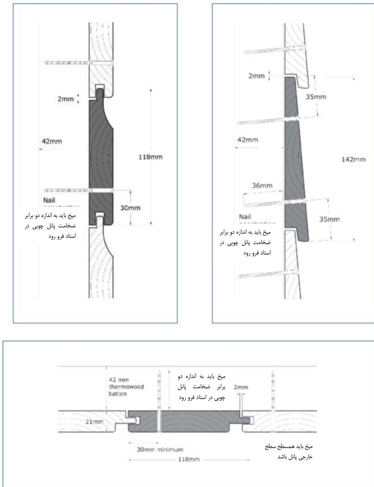
شکل ۱۱-۳۰-نمونه‌هایی از نحوه اتصال پانل‌های چوبی به یکدیگر و استادهای چوبی
