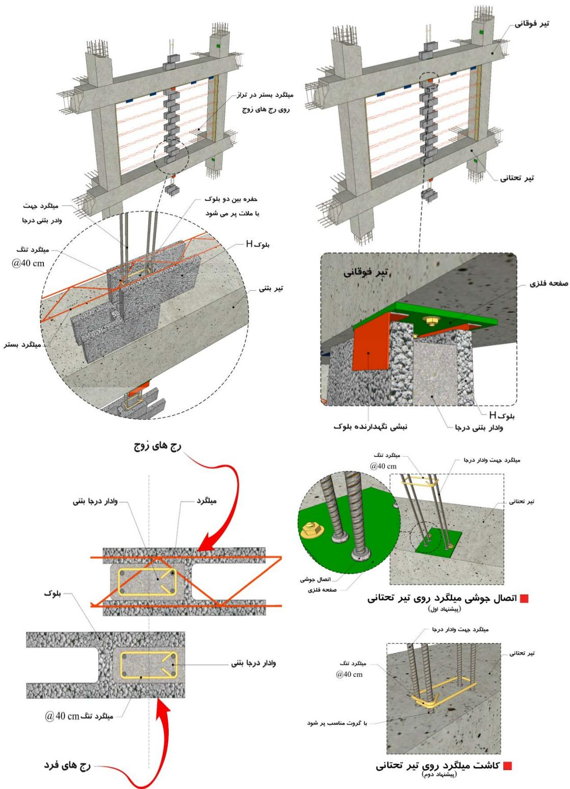
شکل ۸-۱۲- نمونه‌ای از وادر بتونی و جزئیات اجرایی آن در دیوار بلوکی
