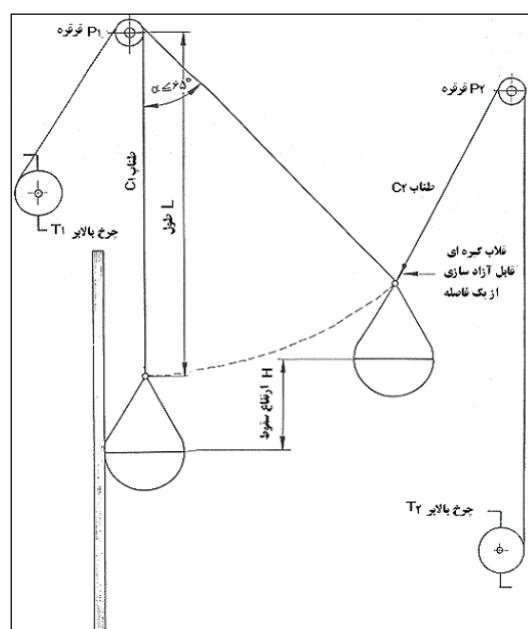
شکل ۴-۳- جزئیات نحوه انجام آزمایش ضربه جسم نرم سنگین
