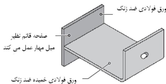
شکل ۹-۴- مهارهای ترکیبی بار ثقلی و جانبی شامل ورقه فولادی ضد زنگ
