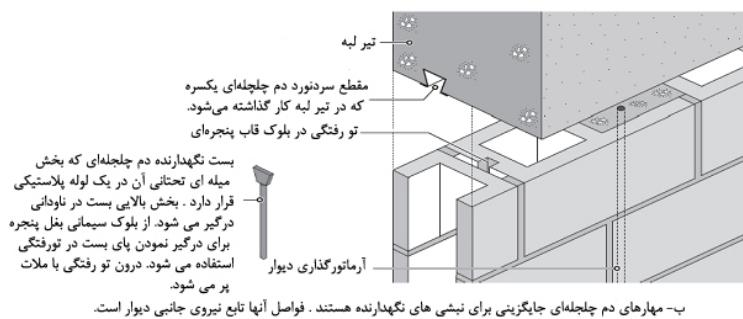
شکل ۲۱-۵- دو روش متداول برای ایجاد مقاومت در برابر بار جانبی در قسمت فوقانی دیوارهای پشتیبان بلوك سیمانی
