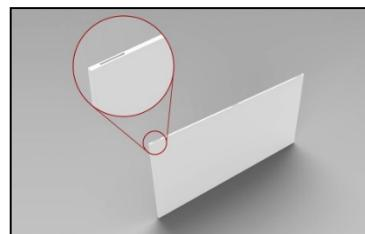
۵- شیار زدن ضخامت سرامیک‌ها
