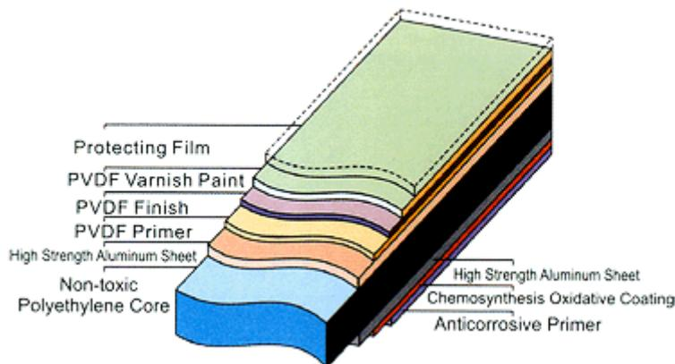
شکل ۱-۸- ساختار لایه‌های پانل
