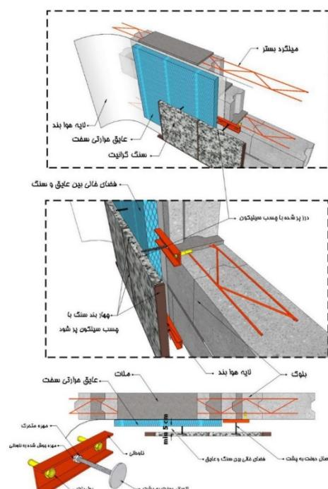
شکل ۱۷-۴ - نمونه‌ای از جزئیات اجرای نمای سنگی خشک بر روی دیوار مصالح بنایی
