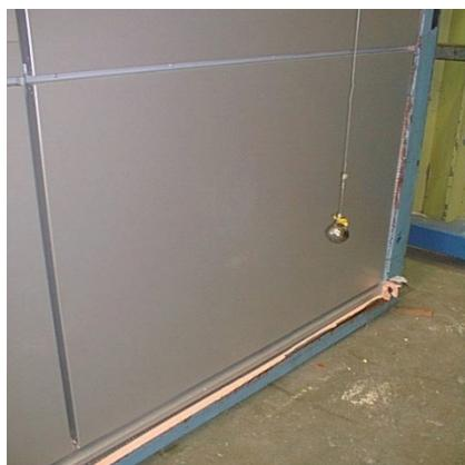
شکل ۳-۲-۳- انجام آزمایش ضربه جسم سخت بر روی نما
