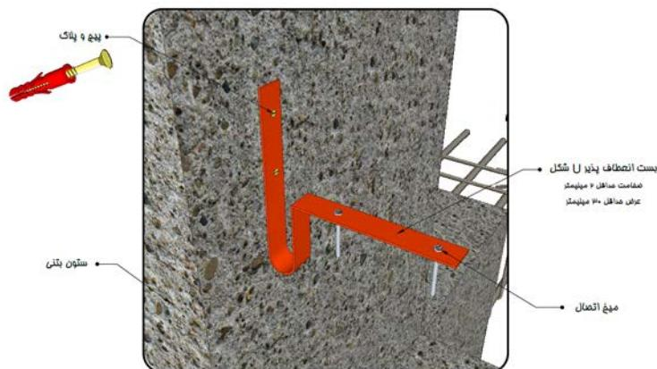
الف- اتصال دیوار خارجی ساخته شده از بلوک به ستون با استفاده از بست انتعطافپذیر U شکل
