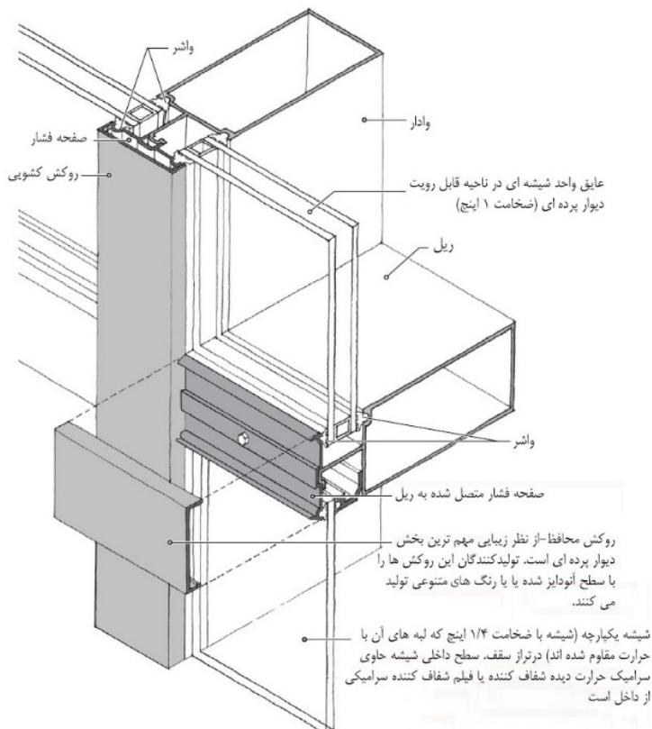
شکل ۹-۱۳- نمای پرده‌ای شیشه‌ای نصب شده از خارج (صفحة تحت فشار نگهدارنده شیشه)
