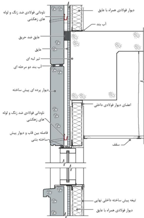
شکل ۱۰-۱۰ جزئیات شماتیک نمایهای بتنی پیش ساخته دارای قاب فولادی
