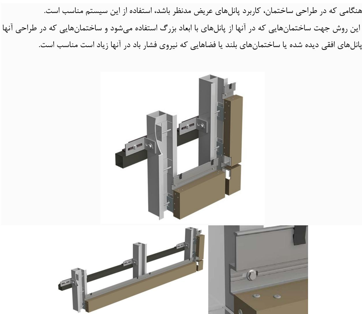
شکل ۸-۵- نمونه‌ای از روش اجرای ثابت -ریلی
