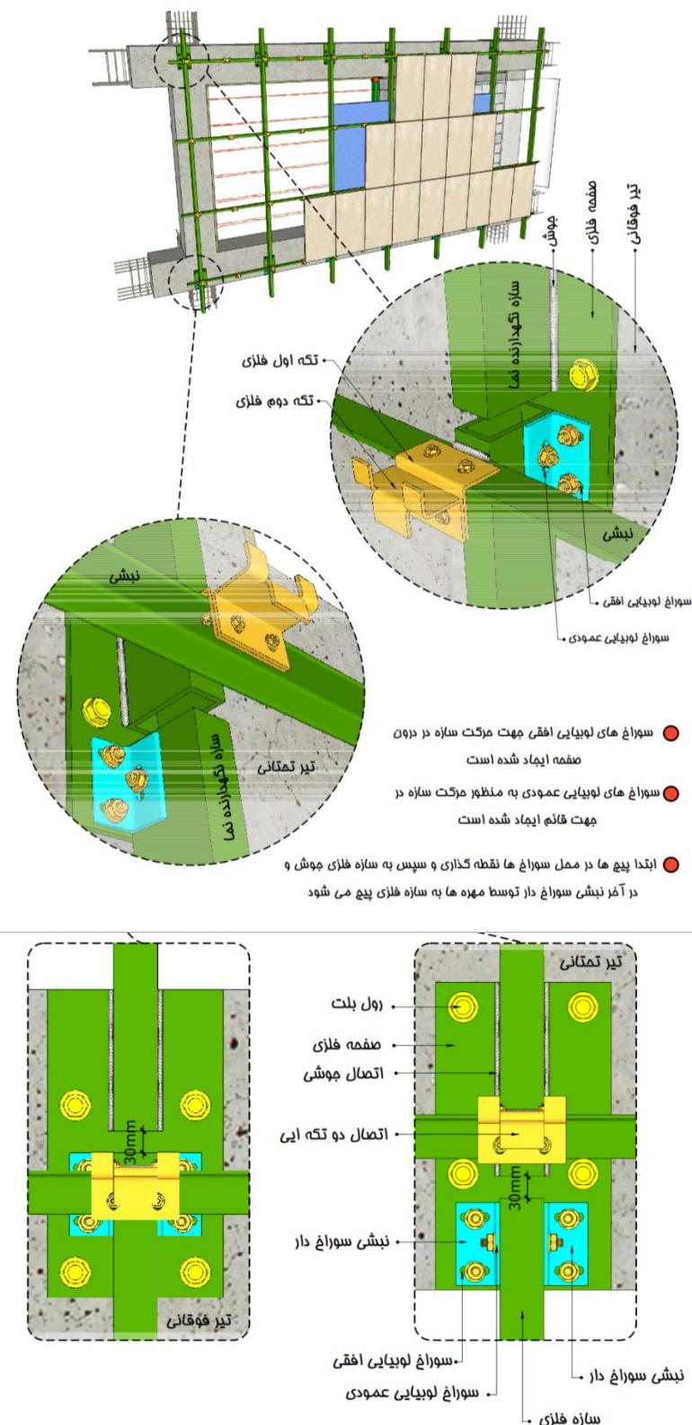
شکل ۴-۱۶-اجرای سوزاخ لوبیاپی در نیشی اتصال نما خشک برای جلوگیری از انتقال جابجایی نسبی طبقات به نما
