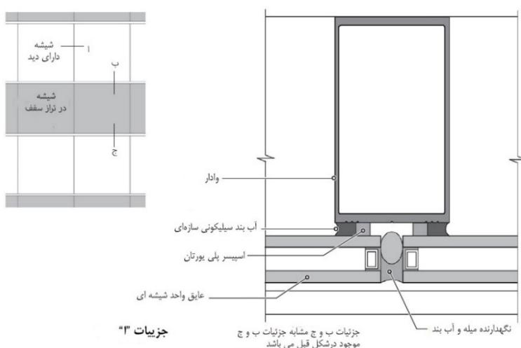
شکل ۱۶-۹ جزئیات نمای پرده‌ای شیشه‌ای با شیشه نصب شده از خارج (آب‌بند سیلیکونی سازه‌ای چسبیده به شیشه)
