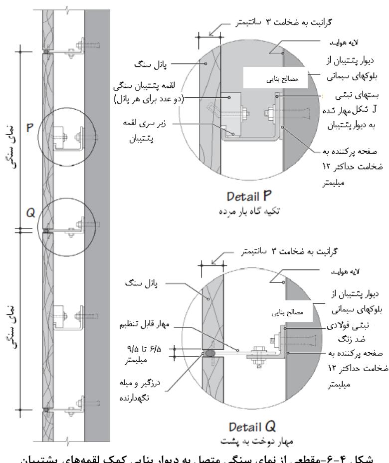
شکل ۴-۶-قطعی از نمای سنگی متصل به دیوار بنایی کمک لقمه‌های پشتیبان
