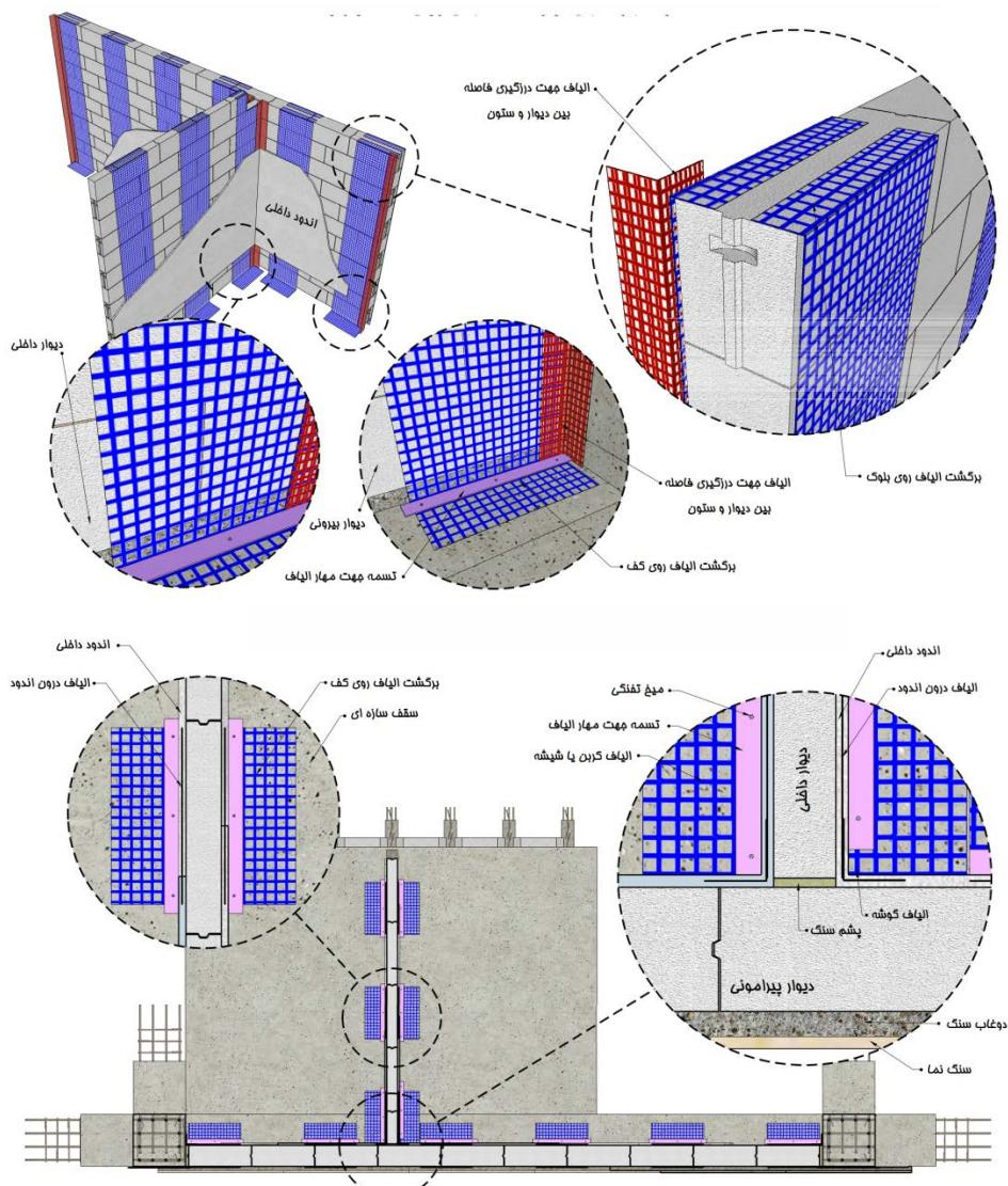
شکل ۱۲-۲۳- نحوه اجرا و تسليح دیوارهای متقطع با استفاده از مش الیاف
