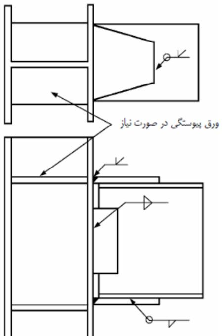
شکل ۳-۶- اتصال ورق به بال تیر با جوش
