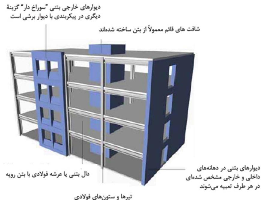
شکل ۱-۹- قابهای فولادی با دیوارهای برشی بتنی
