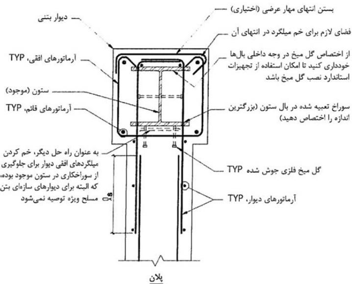
شکل ۷-۸- مدفون شدن ستون در دیوار بتونی درجا
