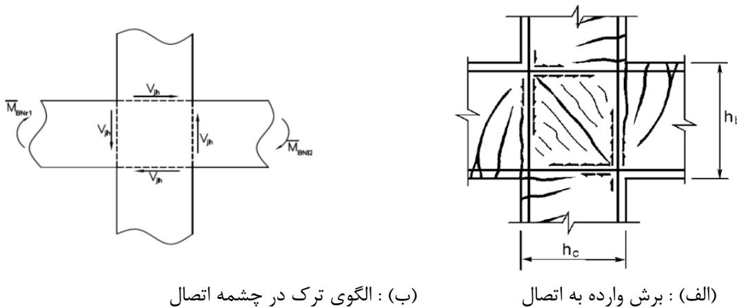
شکل الف-۲- اتصال داخلی تیر- ستون در هنگام بارهای لرزه‌ای
