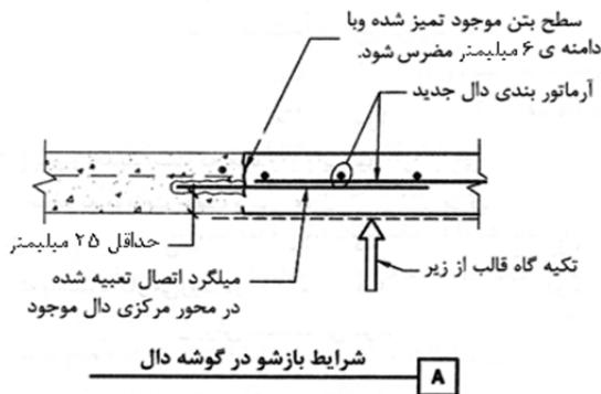
شکل ۱-۱۰- پر کردن بازشو در دیافراگم بتنی
