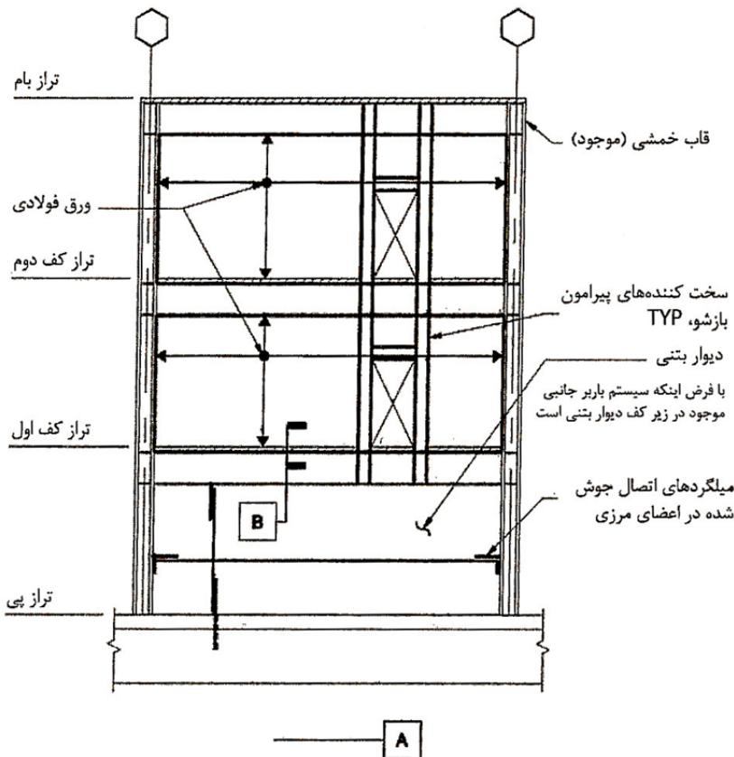
شکل ۷-۲۴- دیوار برشی فولادی بدون سخت کننده
