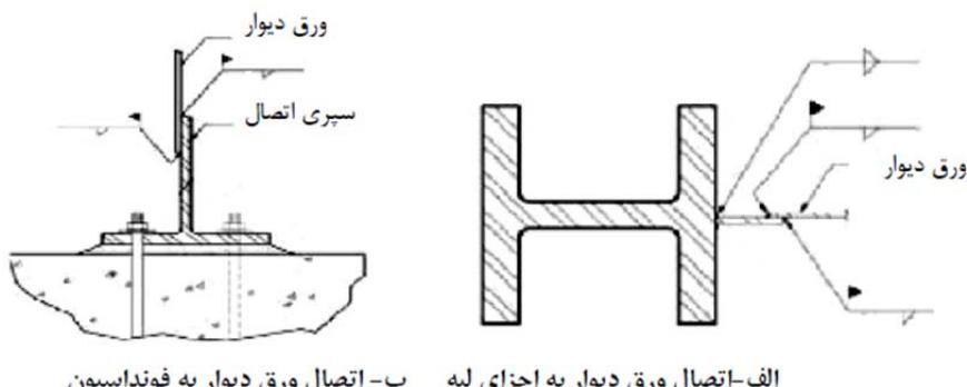
شکل ۶-۶- نمونه‌ای از اتصالات ورق دیوار
