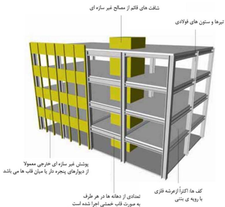
شکل ۱-۷- نمونه‌ای از قابهای خمشی فولادی
