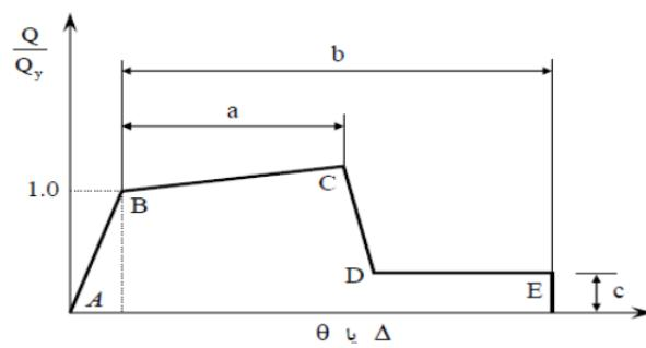
شکل ۱-۶- منحنی نیرو- تغییر شکل تعیین یافته برای اعضا و اجزای فولادی
