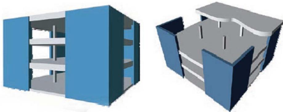
شکل ۷-۶- بهسازی لرزه‌ای قاب‌های موجود بوسیله افزودن دیوارهای برشی
