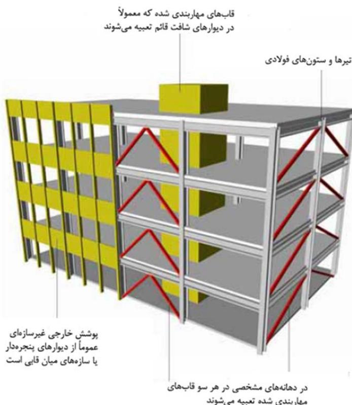
شکل ۱-۸- قابهای مهاربندی فولادی
