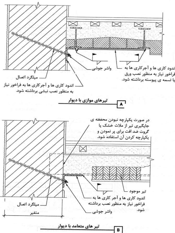
شکل ۴-۱۵- افزودن مهارهای دوخت و عضو مرزی دیوار به دیافراگم طاق ضربی - در صورت دسترسی از زیر کف
