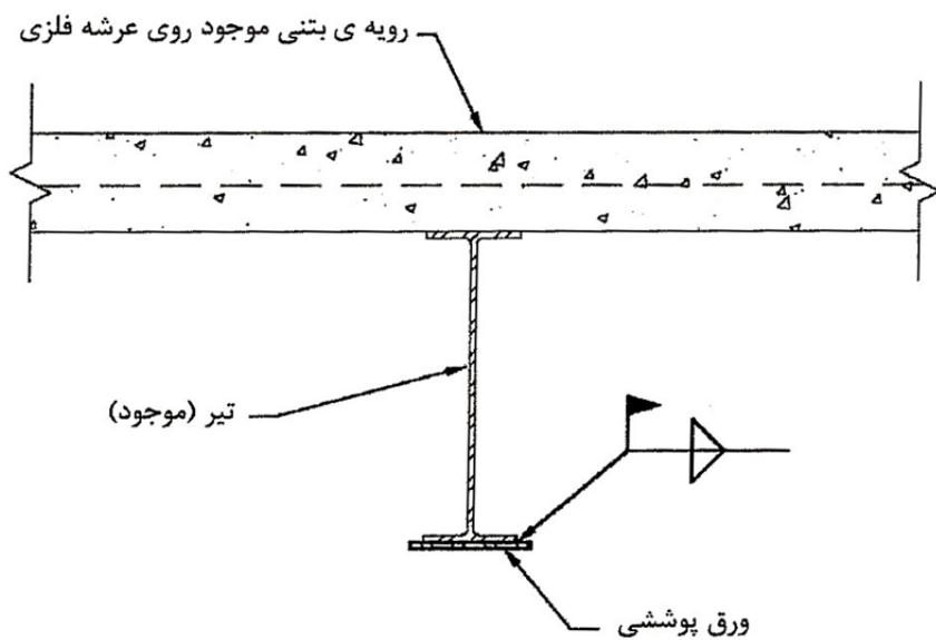
شکل ۱۲-۷- استفاده از ورق پوششی (تقویتی) در تیر موجود
