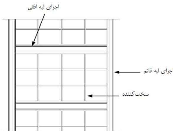
شکل ۶-۵- نمای دیوار برشی فولادی سخت شده
