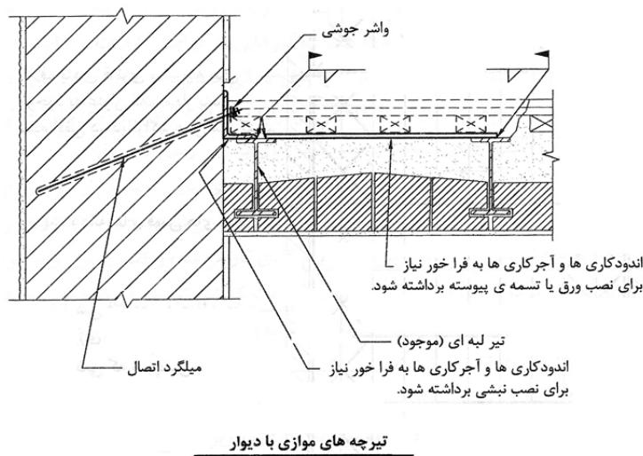
شکل ۵-۱۰- افزودن مهارهای دوخت و عضو مرزی دیوار به دیافراگم طاق ضربی - در صورت دسترسی از بالای کف
