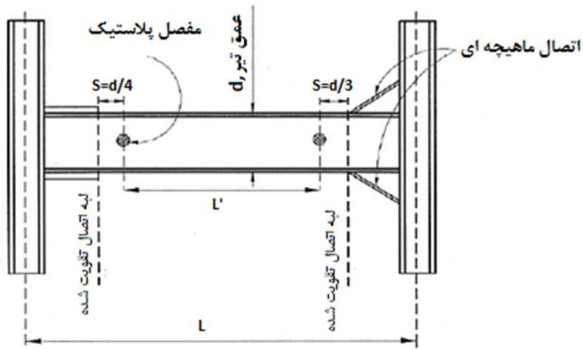
شکل ۲۱-۷- نمونه محل تشکیل مفاصل پلاستیک
