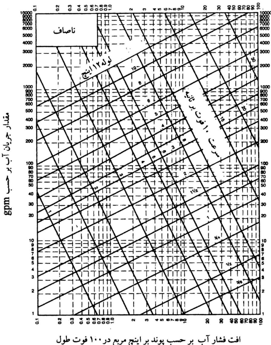
شکل پ ۱-۵-۱ (IP) اندازه گذاری لوله‌های فولادی گالوانیزه با سطح داخلی کاملاً ناصاف
