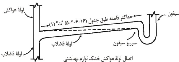
شکل شماره (۱۶-۲-۶ (۵-۲-۶) "ت"): اتصال لوله هواکش خشک لوازم بهداشتی
