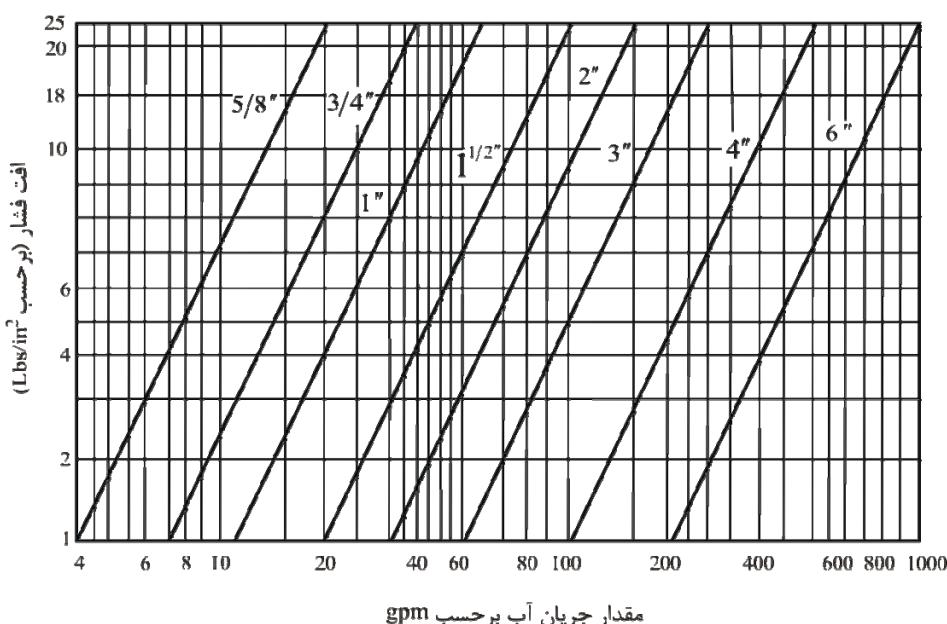
شكل پ ۲-۴-۱ (IP) افت فشار در کنتور نوع دیسکی بر حسب پوند بر اینچ مربع
