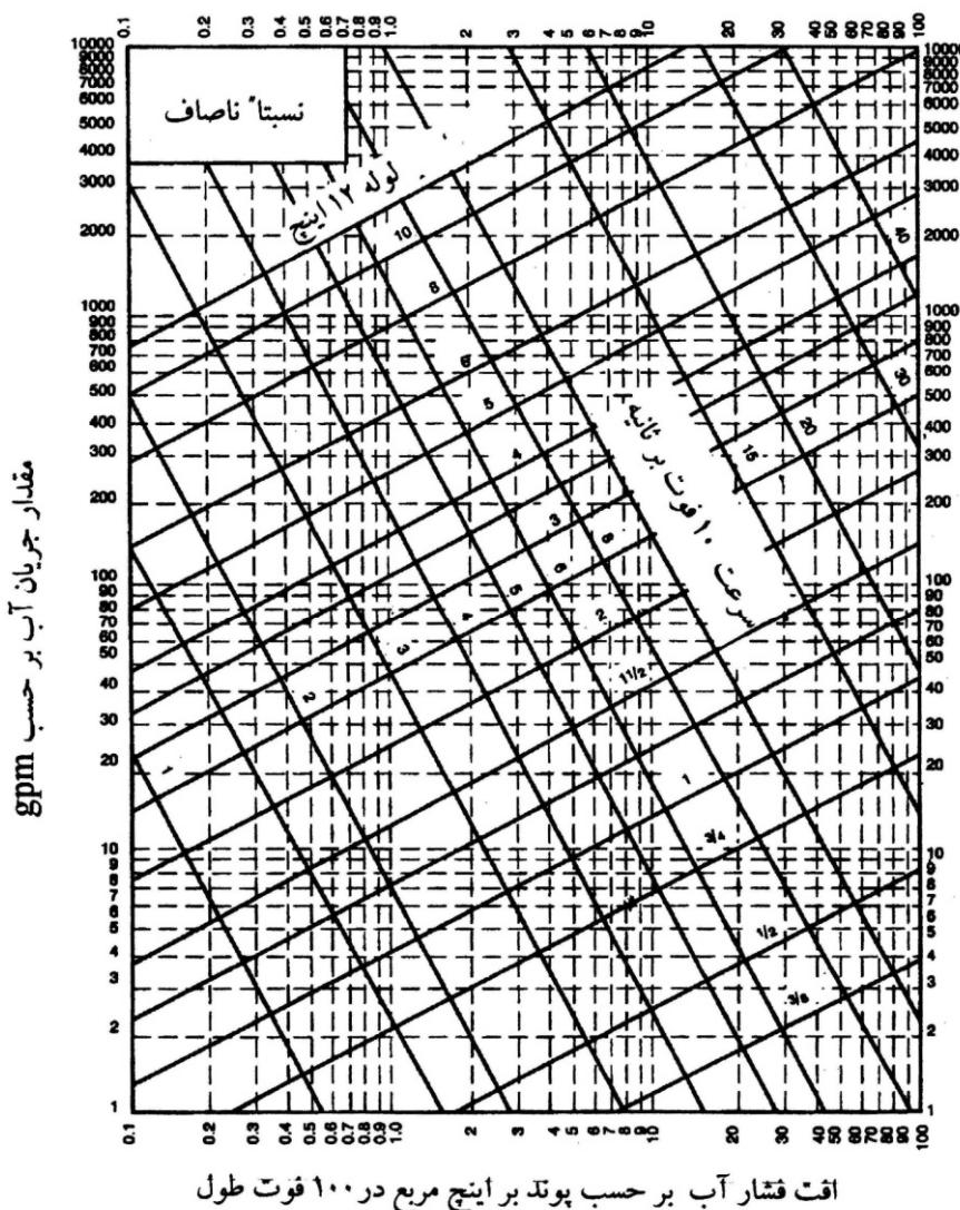
شکل پ ۳-۵ (IP) اندازه گذاری لوله‌های فولادی گالوانیزه با سطح داخلی نسبتاً ناصاف
