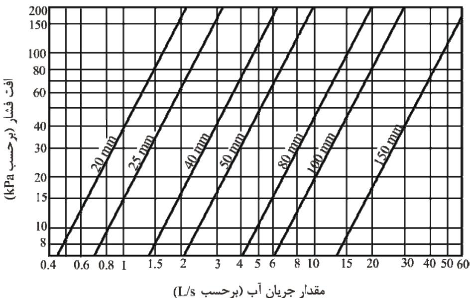
شکل پ ۲-۴-۱ (SI) افت فشار در کنتور نوع دیسکی بر حسب کیلوپاسکال
