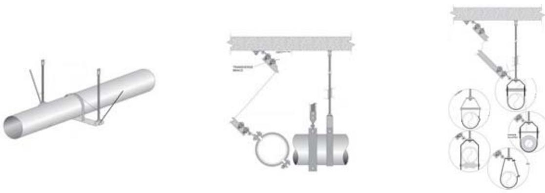
شکل ۲۱-۱۰- مهارهای جانبی برای لوله‌ها
