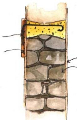
شکل ۱۰-۹ گل میخ‌های برشی برای نصب تسمه لرزه‌ای
