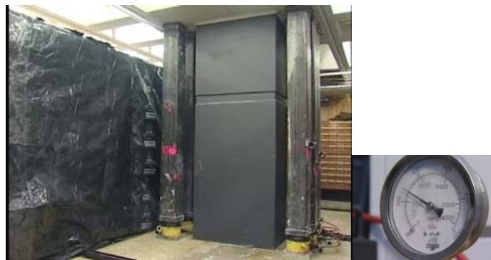
شکل ۶-۱۵- نصب جک‌های هیدرولیکی اطراف ستون جدا شده
