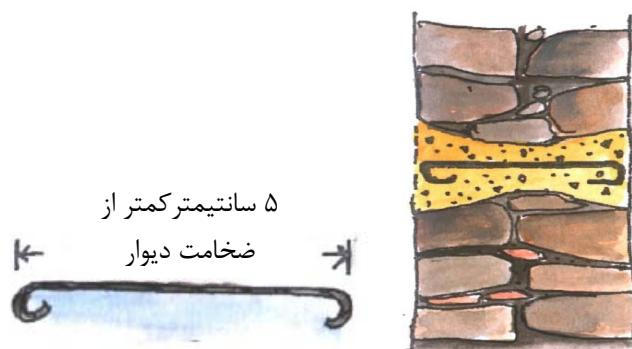
شکل ۳-۹ دو طرف میلگرد داخل عضو همبند باید بصورت قالب باشد
